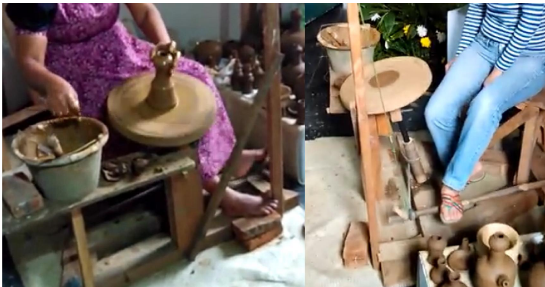
「扯線轉盤」操作實況(左)及結構(右)
